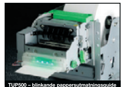
TUP500 – blinkande pappersutmatningsguide
